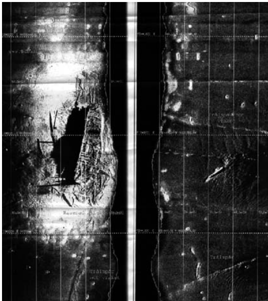
Side scan sonarbild av vrakplatsen där det holländska fartyget ligger. Tre trålsår är synliga. Två går från bildens högra kant och ett från bildens nedre kant.
